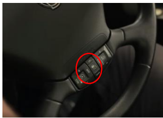
Bouton de réglage au volant de l'ACC
